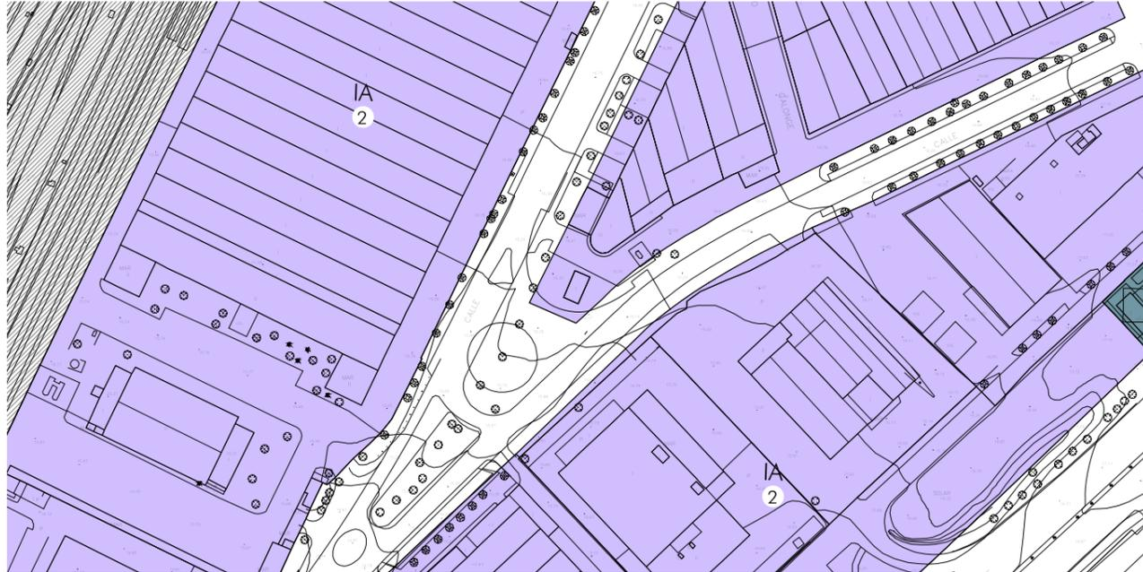
En el Texto Refundido del PGOU se detecta la existencia de un error gráfico en la representación de la alineación exterior de la parcela industrial (IA) que invade el viario existente.
